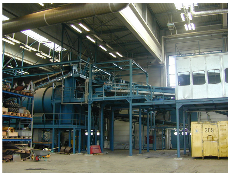
Abbildung 37: Mechanische Aufbereitung: Homogenisierungstrommel (li) und Sortierkabine (re)
