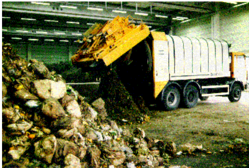
Abbildung 26: Anlieferung von Abfall in einem Flachbunker
