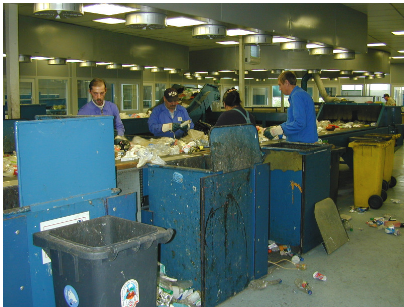
Abbildung 34: Manuelle Aussortierung von Kunststoffen nach einer mechanischen Vorsortierung (deutsche Anlage)
